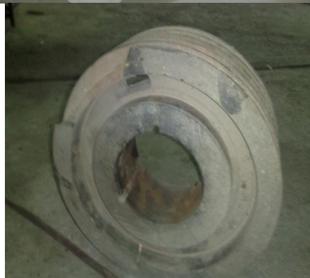
شکل ۶-مربوط به شکستگی پولی
