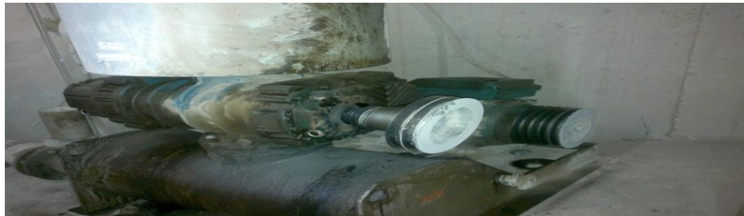
شکل ۴- انتخاب نامناسب پولی ها و خرابی در طول زمان کارکرد
