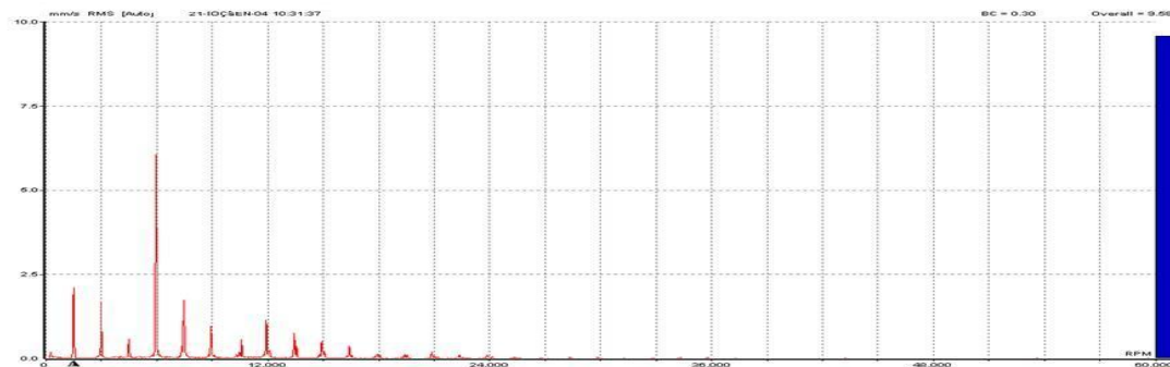
طیف فرکانسی ۲- مربوط به خرابی بیرینگ و گشاد شدن مقر بیرینگ
